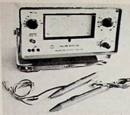
De werkelijke-effectieve waarde meter van Amalgamated Wireless, geschikt voor niveaumeting in telecommunicatieschakelingen.
